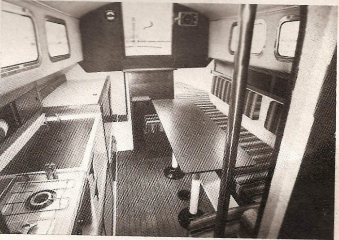
La cuisine dispose de nombreux rangements. Le réchaud appelle deux critiques : le manque d'espace sous le roof et sa position vulnérable près du passage vers l'avant. Nous nous sommes plusieurs fois retrouvés assis sur la suspension.
